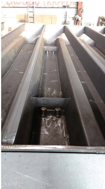
Afbeelding 15. Brugdek (7) troggen bovenplaat
