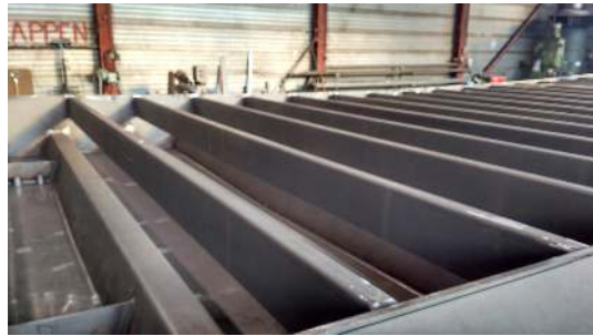
Afbeelding 14. Brugdek (6) verstijvers onderplaat
