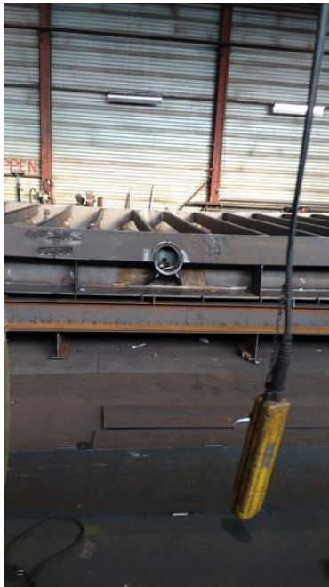
Afbeelding 9. Brugdek met onderdoorvaartlicht inkassing in de rand
