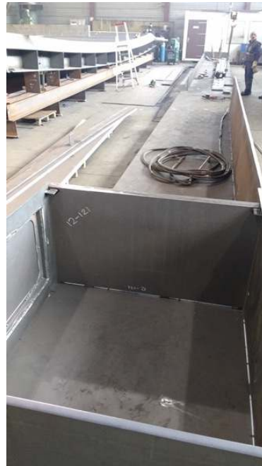
Afbeelding 6. Balans, vanuit de ballastkist gezien
