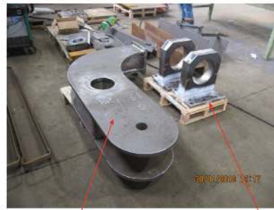
Afgepaste scharnierpunt hangstang / balans en lager stoelen tbv draaipunt val.
