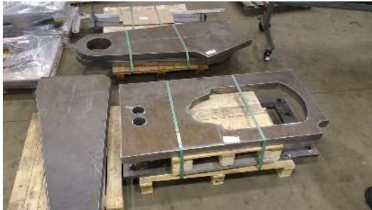
Afbeelding 1. Kop en voetplaat van de hameitoren
